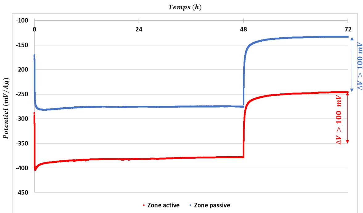
Fig.III. 87- Dalle D_{Cu1} - i \approx 2.65 \text{ mA/m}^2 \text{ d'acier}
