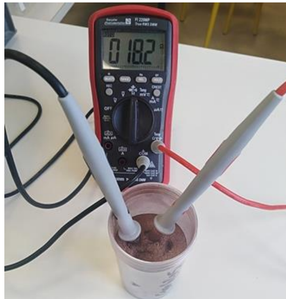
Fig.II. 4- Mesure de la résistance des poudres-pigmentaires
