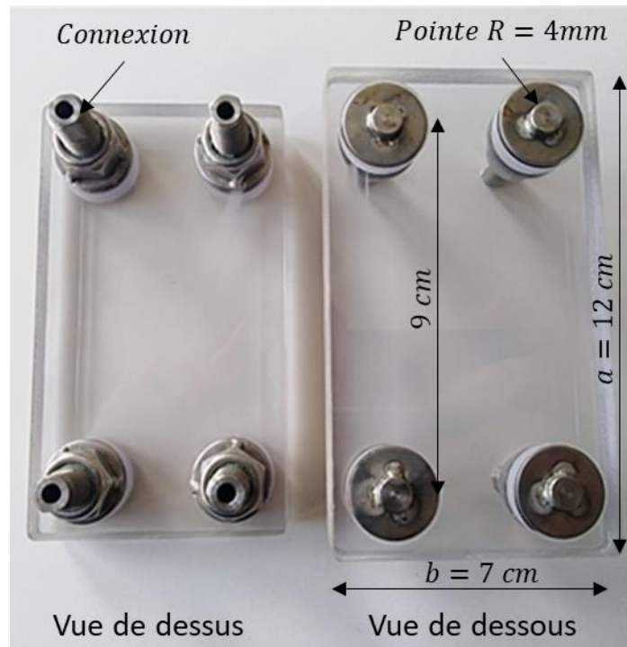
Fig.II. 15- Gabarit de mesure-Van Der Pauw
