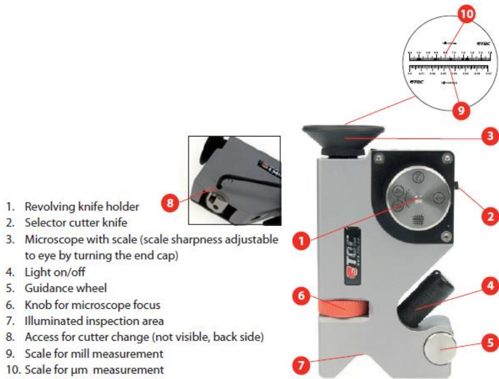
Fig.II. 7- Détail de l'appareil de mesure de l'épaisseur [107]
