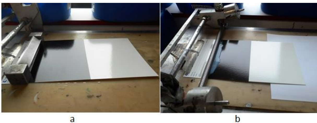
Fig.II. 2- Application par : a-applicateur Bird b-barreau métallique
