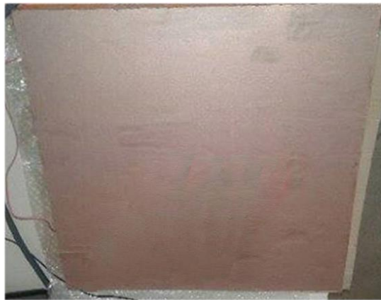
Fig.III. 23- Application du revêtement F_{Cu-Ag} sur la dalle D_{Cu2}
