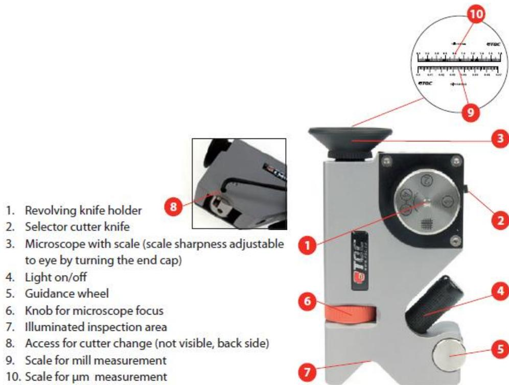
Fig.II. 7- Détail de l'appareil de mesure de l'épaisseur [107]
