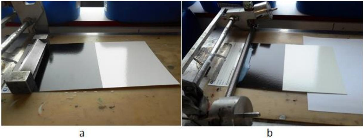
**Fig.II. 2- Application par : a-applicateur Bird b-barreau métallique**
