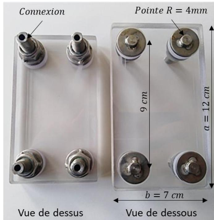
**Fig.II. 15- Gabarit de mesure-Van Der Pauw**
