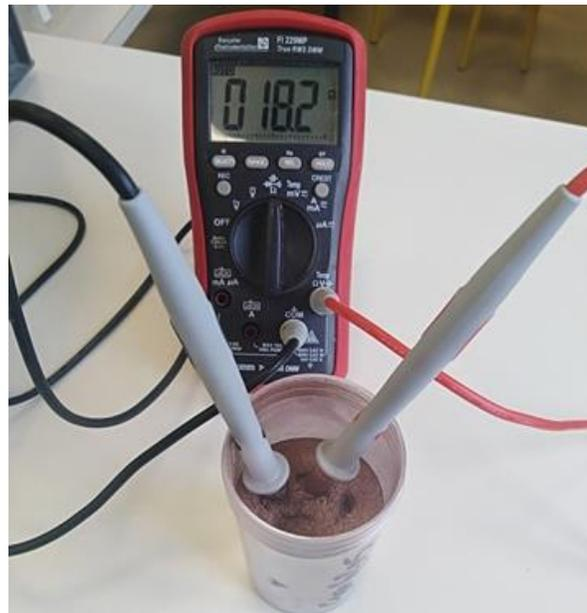
**Fig.II. 4- Mesure de la résistance des poudres-pigmentaires**
