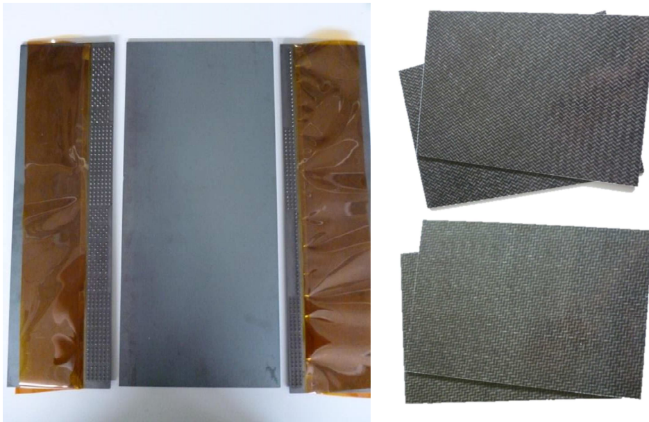
Figure II.44: Les différents composants de l'assemblage, avant l'estampage
