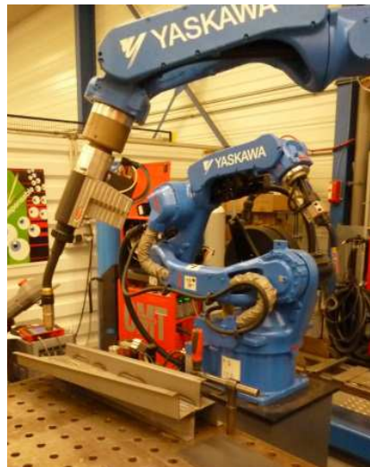
Figure II.42. Robot équipé de la tête de soudage CMT
