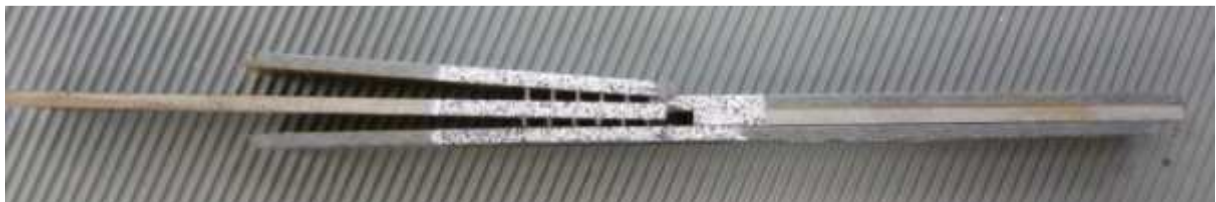
Figure II.62. Rupture asymétrique de l'éprouvette 24 picots, 0°
