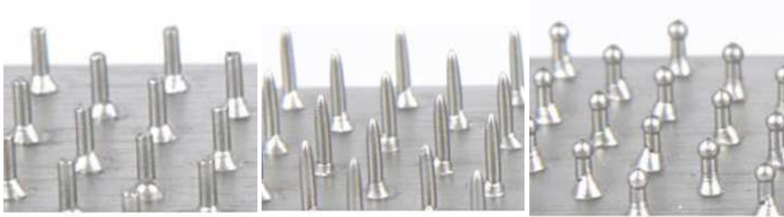
Figure I.17. Différentes géométries de picot, cylindrique, pointe, sphérique. [73]
