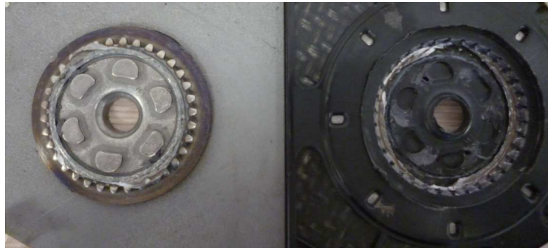
Figure IV.115. Rupture de la soudure sur interface 2
