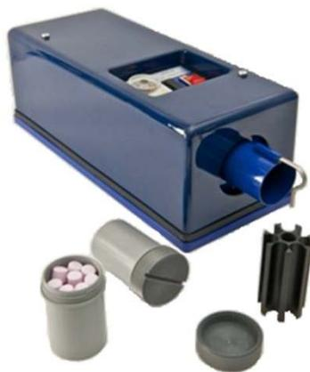
**Figura 13.** Síntesis mecanoquímica. Equipo marca Glen Creston modelo McCrone Micronising Mill
