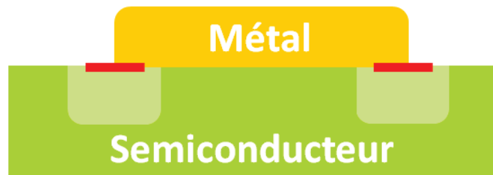
Figure 1.29 : Vue en coupe d'un contact Schottky, avec ajout d'un contact ohmique entre le métal et la protection périphérique
