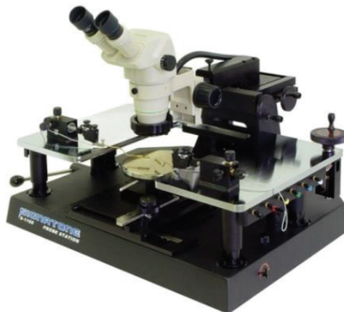
Figure a : Photographie du banc de caractérisation électrique utilisé : Station sous pointe Signatone S1160
