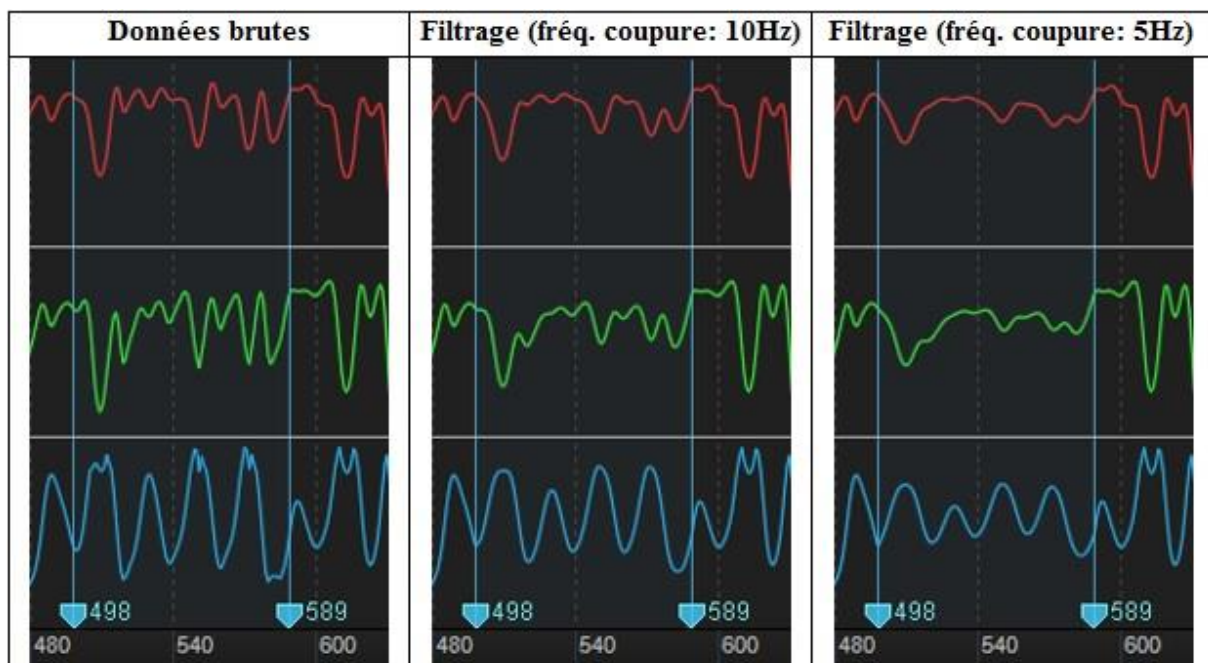
Figure 3-10 : Exemple de filtrage avec une haute fréquence de coupure (10Hz) et une basse fréquence de coupure (5Hz).
