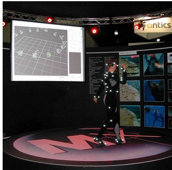
Figure 2-4: Un danseur portant une combinaison avec des marqueurs passifs réfléchissants, lors d'une capture optique de mouvement. (wikipédia).
