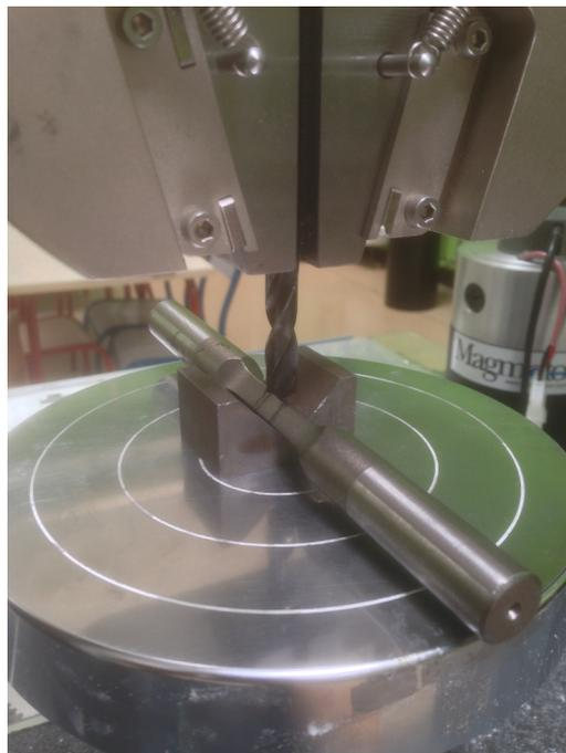
FIGURE 4.10 – Montage pour les indentations quasi-statiques
