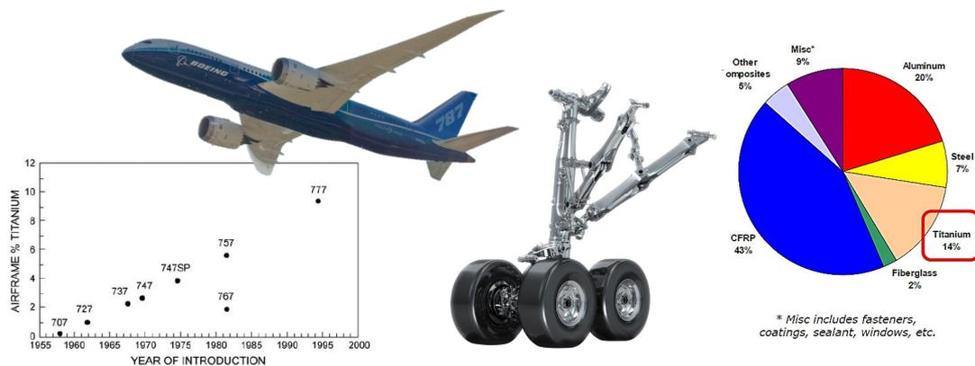
FIGURE 1 – Évolution de l'utilisation des alliages de titane et part des alliages de titane dans les avions contemporains [Peters *et al.*, 2003]
