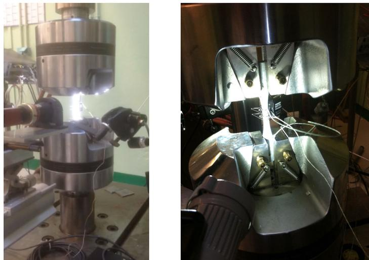
FIGURE 1.20 – Illustrations du montage de traction. (a) Vue globale de l’essai avec caméra et objectif télécentrique G 0,25. (b) Dispositifs de mesure de température par thermocouples et extensomètre à froid
