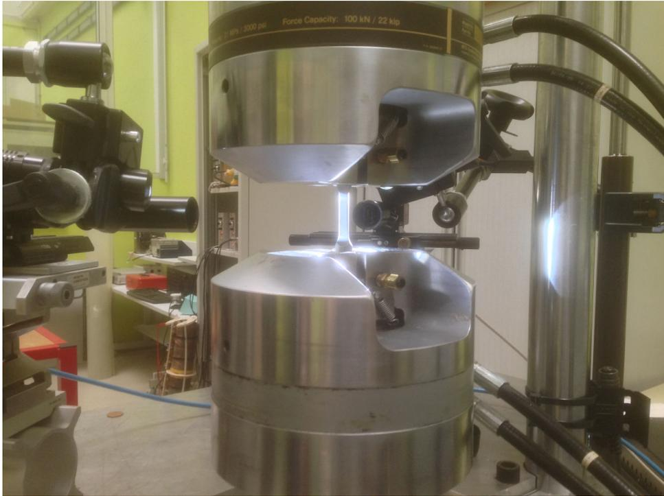
FIGURE 4.14 – Montage d'essai pour les éprouvettes KBR
