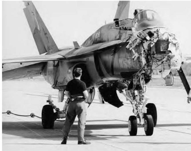
FIGURE 4.1 – Impact en vol de deux avions F/A-18 avec les dégâts associés [Nicholas, 2006a]
