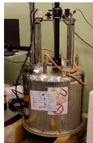
Fig.7 : Représentation schématique (gauche) et photographie (droite) de la bobine d'induction et du Dewar d'aimantation (gauche).
