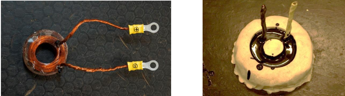
Fig.21 : Photographie de la seconde étape de fabrication de l'inducteur, la bobine démoulée (gauche) est moulé une seconde fois pour l'obtention d'une géométrie adéquate.
