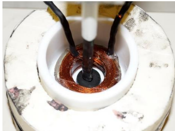
Fig.10 : photographie du montage d'aimantation par champ pulsé dans l'azote liquide.
