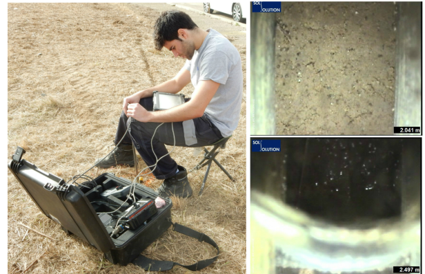
FIGURE 3.11 – Exemples de la réalisation de l'essai de géondoscopie sur terrain et d'images obtenues
