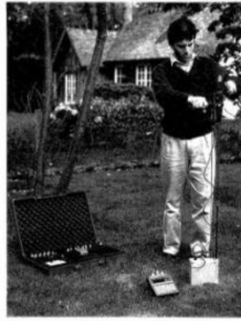
Pénétrömètre dynamique léger à énergie variable pour la reconnaissance des sols
