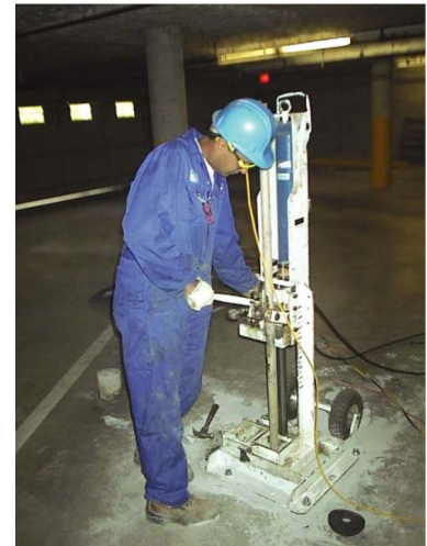
FIGURE 3.2 – CPT sur dispositif portable pour des zones d'accès limité (source : Robertson and Cabal (2015))
