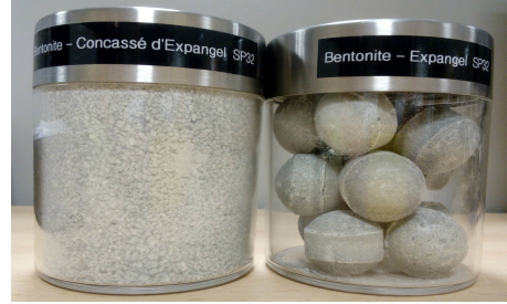
FIGURE 13.1 – Photo des deux composés de bentonite : concassé à gauche et pellets à droite
