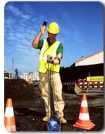
FIGURE 3.4 – Exemple de réalisation d'un sondage Panda
