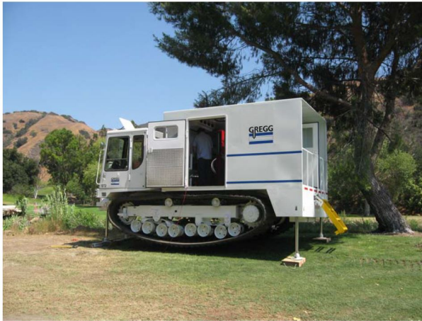
FIGURE 3.1 – CPT monté sur un camion (source : Robertson and Cabal (2015))
