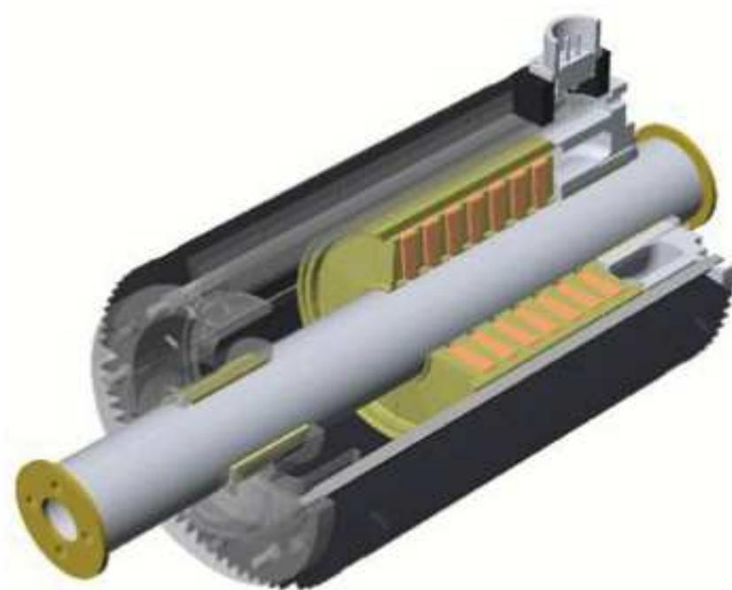
Figure 1. 5: Machine linéaire tubulaire (cylindrique) [Gie&AL12][Bol&16b].
