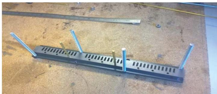
Figure 4.3 : Dispositif de serrage du circuit magnétique.
