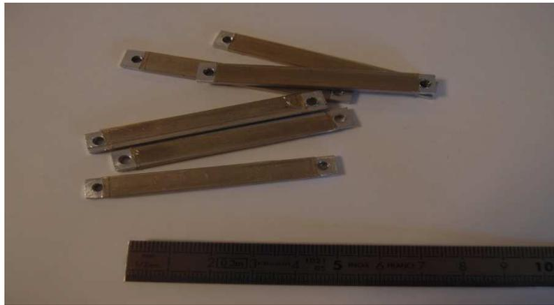
Figure 4.8 : Barres de bobinage enrubanné du 3M 5490.
