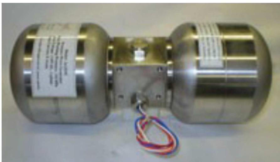
Figure 1. 39: Moteur/générateur couplés avec leur enceinte [Bac&AL99].
