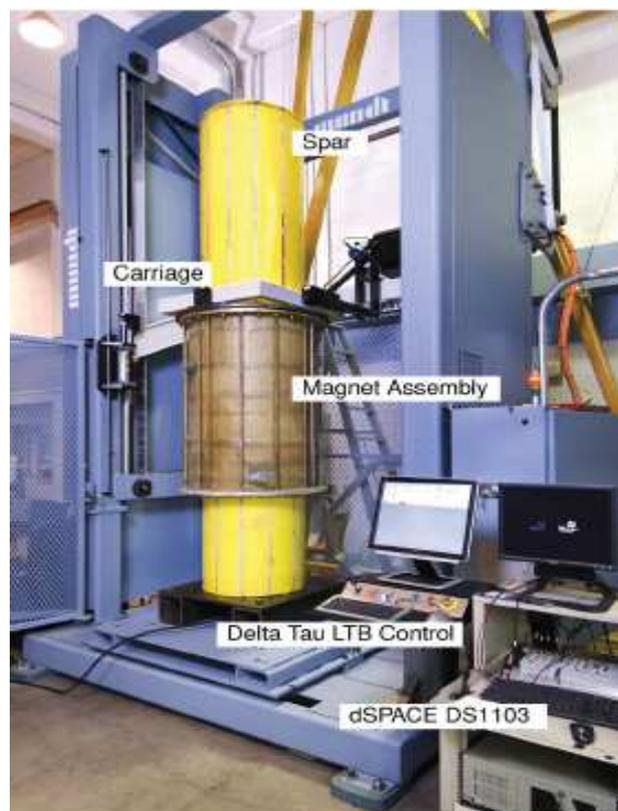
Figure 1. 24: Machine électrique linéaire tubulaire [Pru&AL10].
