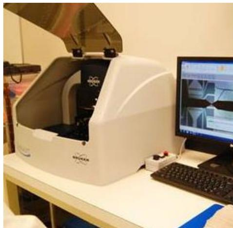
FIGURE 3.16 – *Photographie de l'instrument de mesure d'épaisseur, DEKTAK XT*
