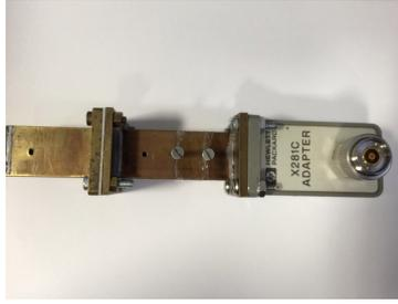
FIGURE 3.21 – Cavité pour la mesure de  $\varepsilon^*$
