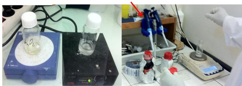
FIGURE 3.6 – Banc de préparation sol-gel
