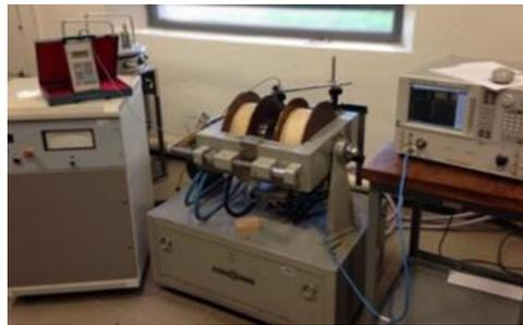
FIGURE 3.24 – Photographie du banc de mesure de  $\mu^*$  équipé de la cavité et d'un électroaimant
