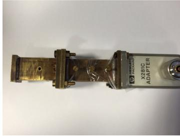
FIGURE 3.22 – Cavité pour la mesure de  $\mu^*$
