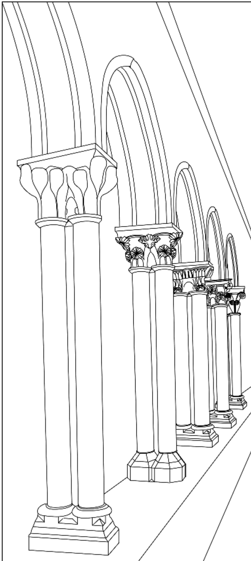
Doc. 113. Hypothèse de remontage à l'échelle de bases, colonnettes et chapiteaux identifiés provenant du cloître de l'abbaye de la Casedieu (vers 1300 ?). Dessin S. A., 2014.
