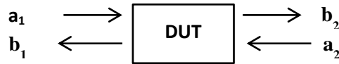
Figure 6.5. Ondes indentes et réfléchies sur un composant sous test (DUT) par un analyseur de réseau vectoriel à 2 ports
