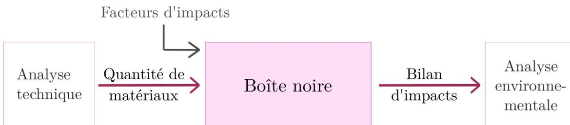
FIGURE 1.2 – Modèle général de description d'un système
