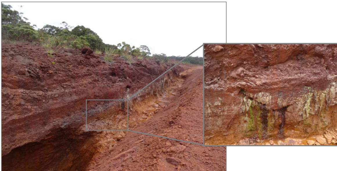
Figure 146 : Ecoulement souterrain à l'interface des niveaux de cuirasse et des latérites.
