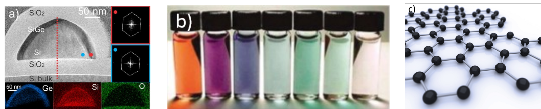
FIGURE 1.9 – a) Exemple de nanocrystal cœur-coquille SiGe/Si [46], b) Différentes couleurs dues à une structure cœur-coquille Au-SiO 2 , cœur de 60 nm et variation de l'épaisseur de la coquille [47], c) représentation schématique du graphène
