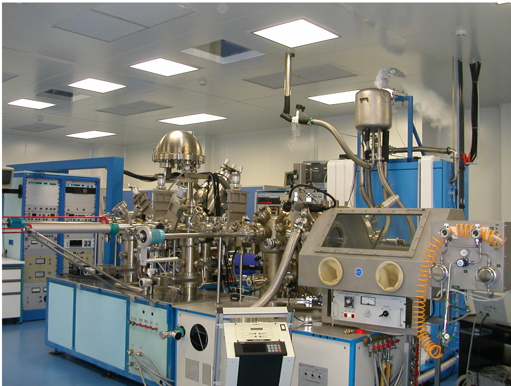
FIGURE 2.6 – Photo générale de l'ancien bâti RIBER-MBE 32 de l'équipe avec chambre d'analyse VSW
