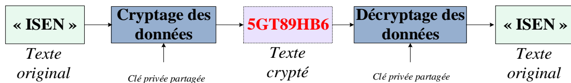
Figure 4. 2 - Schéma bloc de la cryptographie symétrique
