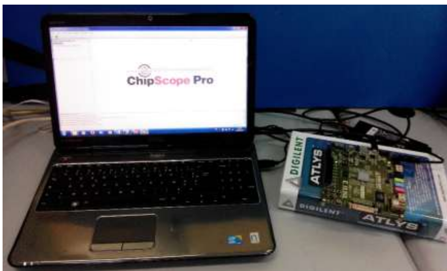
Figure 3. 28. Banc de test pour la validation réelle avec chipscope sur FPGA SPARTAN 6
