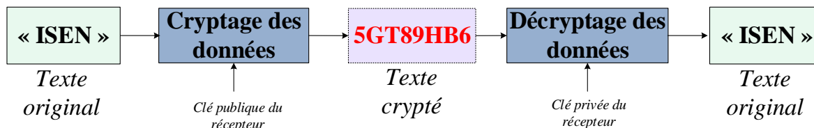
Figure 4.3 - Schéma bloc de la cryptographie asymétrique [Havet 10]
