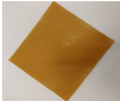
Figure 2-2. Couche viscoélastique en caoutchouc naturel.
