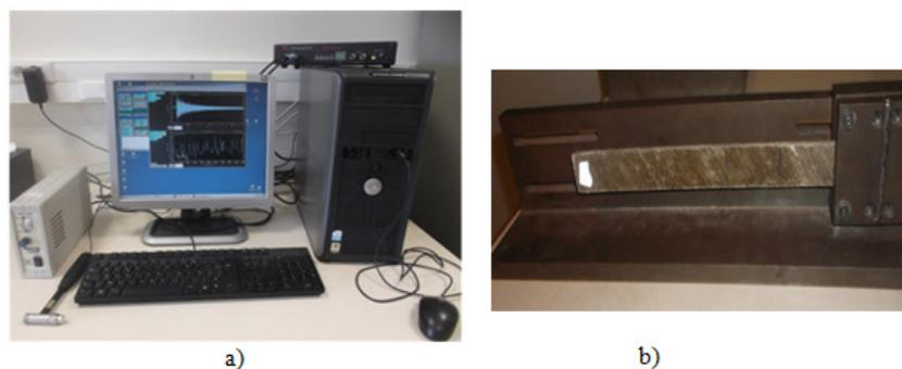
Figure 3-3. Analyse expérimentale: a) Dispositif expérimental, b) Eprouvette encastree/libre.
