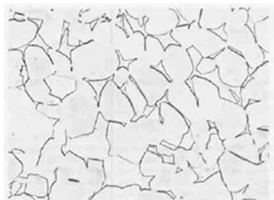
(f) microstructure équiaxe après refroidissement à 100 °C/min après chauffage à 950 °C Gr 1100 ×
