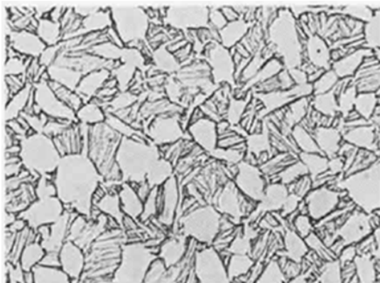
(e) microstructure équiaxe après refroidissement rapide à l'air après chauffage à 950 °C Gr 1100 ×
