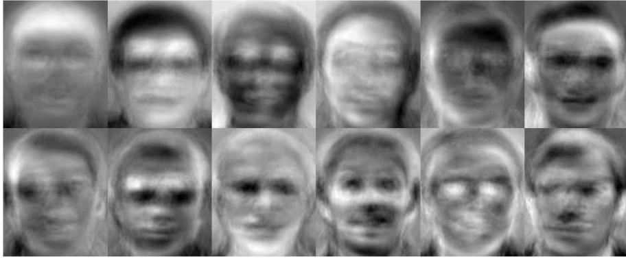
Figure 2.1: Visages propres (vecteurs propres) des 12 plus grandes valeurs propres sont présentés provenant de la division ATT de la base de données ORL [81].
