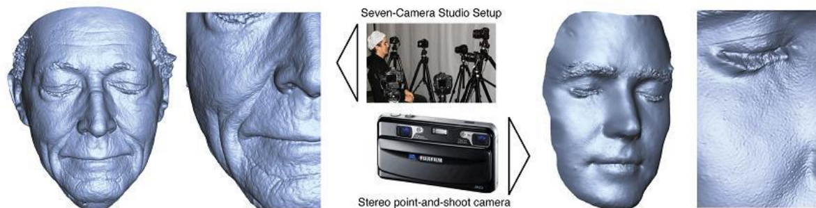
Figure 1.8: Gauche: modèle de visage capturé en utilisant une configuration de studio de sept caméras, centre: systèmes de capture, droite: modèle de visage capturé avec la caméra stéréo binoculaire des consommateurs [42].
