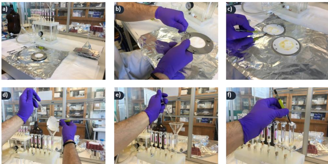
Figure 47. Etapes de mise en cartouches des POCIS suite à leur exposition (a : décongélation à température ambiante, b : démontage du POCIS, c : POCIS ouvert en deux parties, d : rinçage des membranes et collecte de la phase, d : rinçage de l'entonnoir et de la cartouche, e : remise en place du fritté en téflon)
