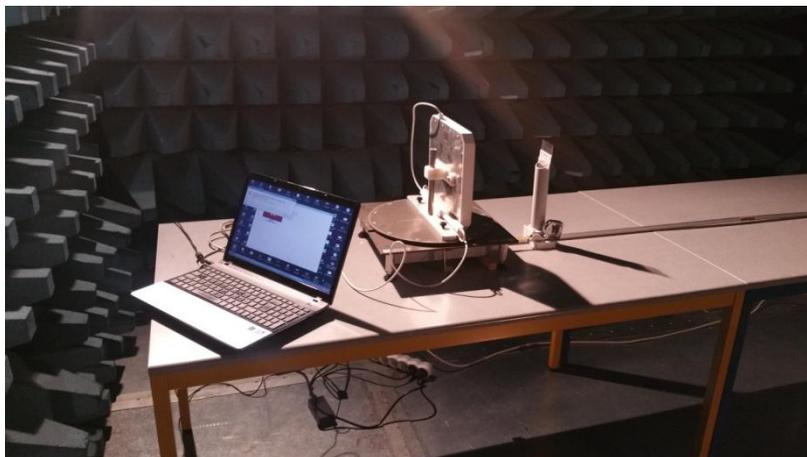
Figure 3.10. Le banc de mesure monté dans la chambre semi anéchoïque.
