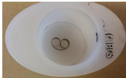
Figure 4.3. Tag dans le moule d'enrobage à froid.
