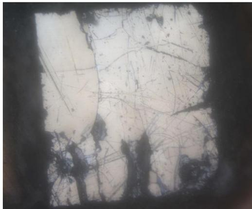
Figure A.4.2. Vue optique du RFIC d'un tag Web vieilli à 160 ( $\pm 5$ ) °C.
