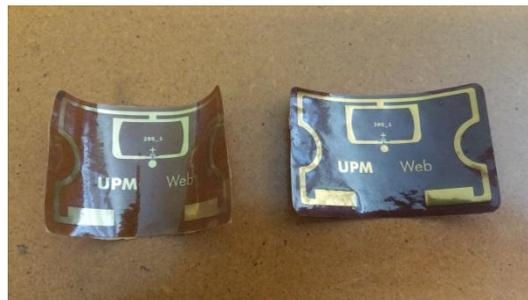
Figure 3.6. Vue des tags Web vieillis à  $140 (\pm 5) ^\circ\text{C}$ .
