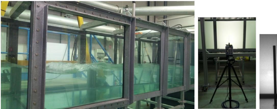
**Figure VI-16.** Installation expérimentale utilisée pour mesurer l'amplitude des déformations et la fréquence d'oscillation des cylindres souples. De gauche à droite : canal expérimental à surface libre (12 m de long avec une largeur et une hauteur de 1 m, débit max  $1800$  m<sup>3</sup>.h<sup>-1</sup>), caméra rapide LaVision et image instantanée d'un cylindre dans l'écoulement.
