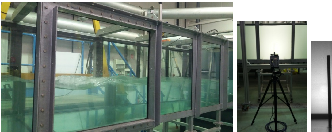
Figure VI-16. Installation expérimentale utilisée pour mesurer l'amplitude des déformations et la fréquence d'oscillation des cylindres souples. De gauche à droite : canal expérimental à surface libre ( 12 m de long avec une largeur et une hauteur de 1 m, débit max 1800 m 3 .h -1 ), caméra rapide LaVision et image instantanée d'un cylindre dans l'écoulement.
