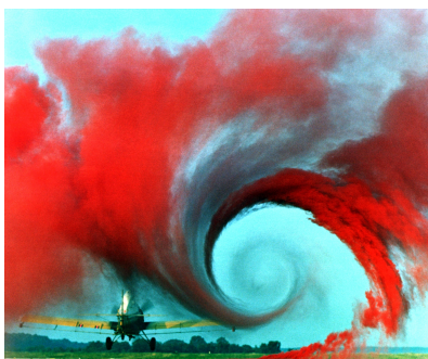
FIGURE 1.3.1 – Étude de la turbulence de sillage d'une aile d'avion sur l'île Wallops 5
