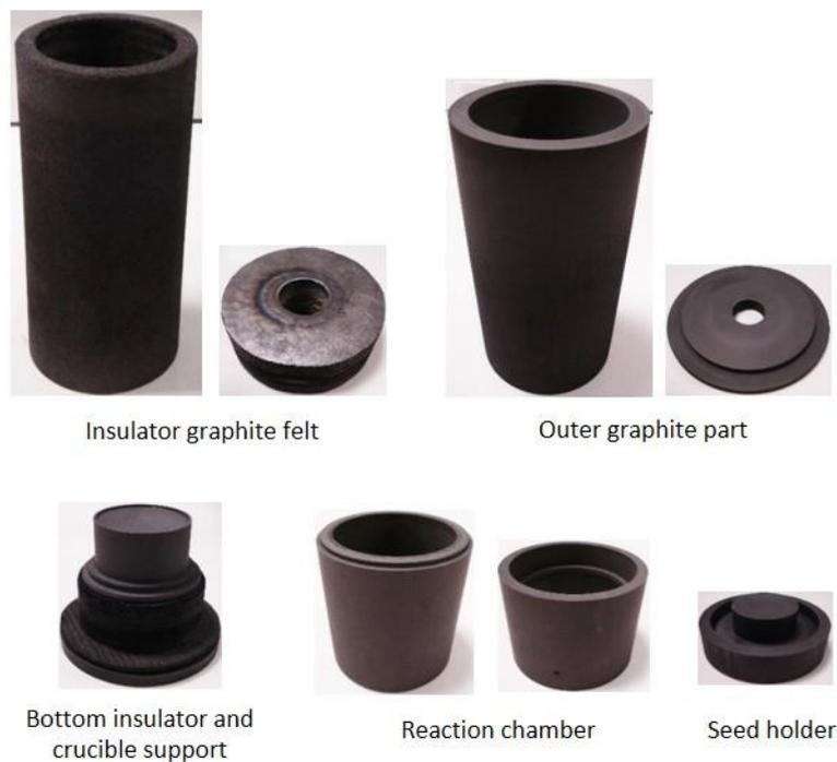
Figure 6: Parties principales du creuset en graphite externe utilisé pour les expériences.
