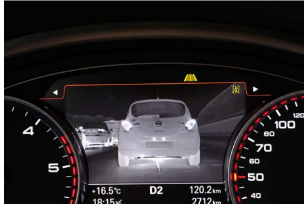
FIGURE 1.3 – Système d’assistance à la vision de nuit Audi A8.
