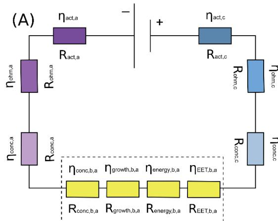
**Figure 1.5. Circuit électrique équivalent d'une BPCM.** Circuit électrique équivalent d'une BPCM composée d'une bioanode et d'une cathode abiotique telle que représentée dans la Figure 1.3. Chaque surtension est associée à une résistance. Les résistances violettes et bleues correspondent respectivement aux mécanismes abiotiques du compartiment anodique et cathodique. Les résistances jaunes correspondent aux mécanismes biotiques du biofilm anodique.
