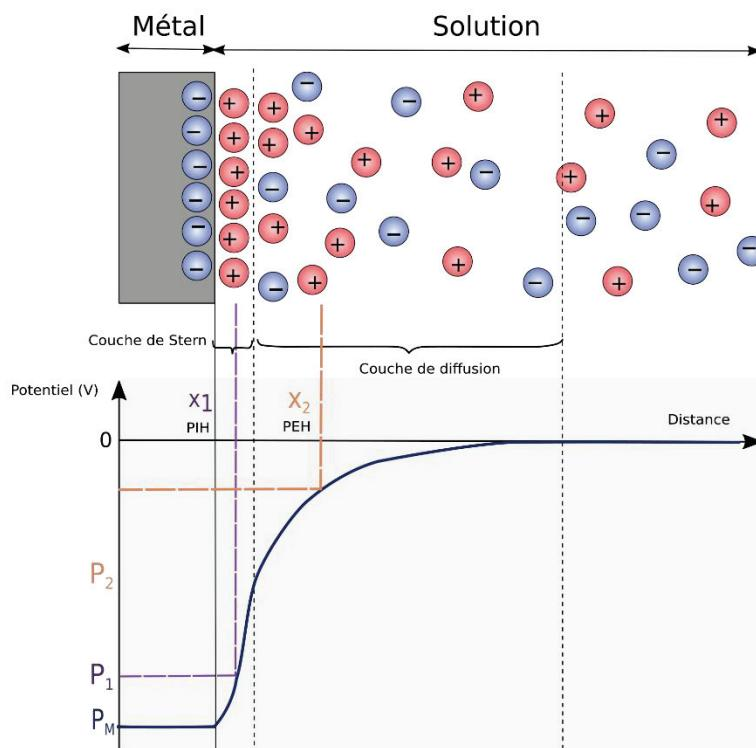
**Figure 1.4. La double couche électrique.** Ce schéma représente la distribution des charges à l'interface électrode/solution et l'évolution du potentiel de l'électrode à la solution.
