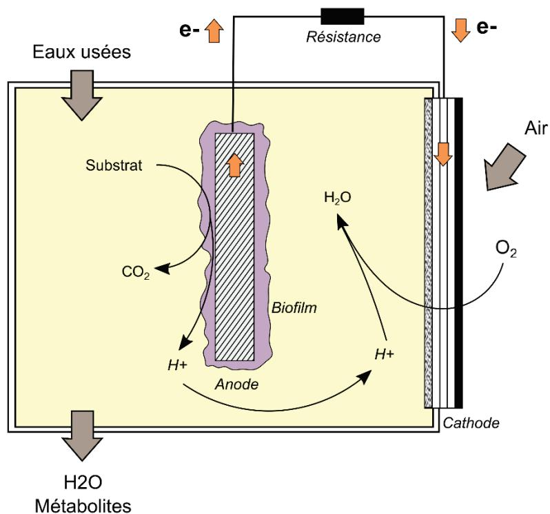
**Figure 1. Schéma d'une biopile à combustible microbienne.**
