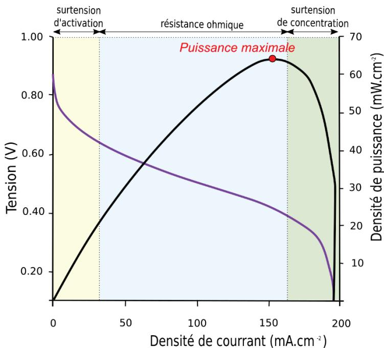
**Figure1.2. Courbe de polarisation et de puissance.** La courbe violette représente la tension de la pile en fonction de l'intensité. La courbe noire représente la densité de puissance en fonction de l'intensité.
