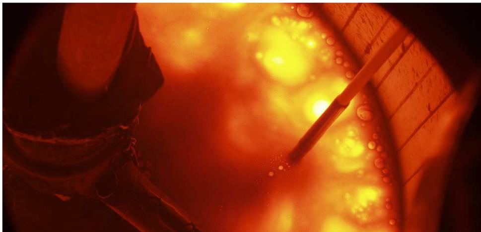
Figure 1.2 – Photographie de l'intérieur du creuset froid lors de la fusion de verre - l'agitateur mécanique se trouve ici hors du bain, couvert de verre solidifié
