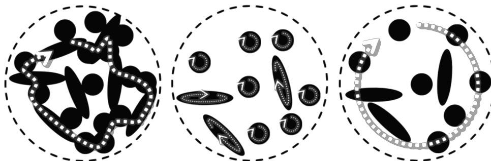
Figure 4.10 – Représentation schématique des courants électriques dominants dans une suspension de particules plus conductrices que la matrice soumise à induction électromagnétique - de gauche à droite, le cas percolé C \geq C_p , le cas non percolé C < C_p où les courants intraparticulaires dominent et le cas non percolé C < C_p où les courants macroscopiques dominent
