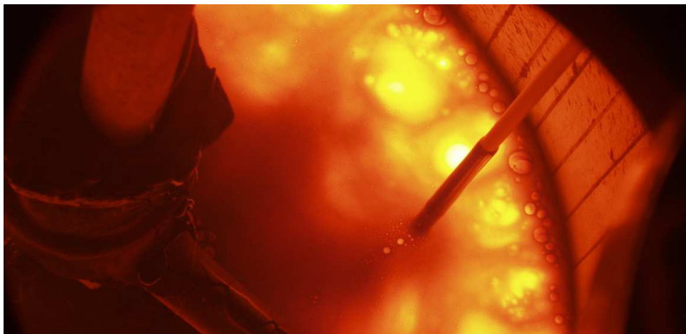
Figure 1.2 – Photographie de l'intérieur du creuset froid lors de la fusion de verre - l'agitateur mécanique se trouve ici hors du bain, couvert de verre solidifié
