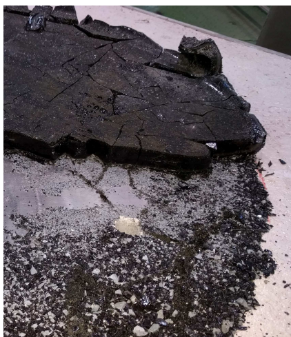
Figure 7.11 – Reliquat de verre présent sur la sole du creuset après vidange totale (en cours de retrait) - couche de fritte de verre restante après retrait du reliquat de verre coalescé
