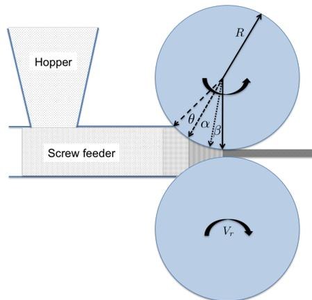
Figure 1: Représentation schématique du processus de compactage à rouleaux
