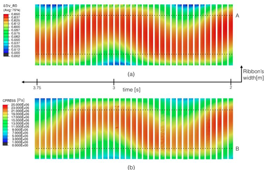
Figure 9: Densité relative (a) et pression de contact (b) au cours du procédé. Résultats de simulation obtenue par combinaison de méthodes DEM et FEM.
