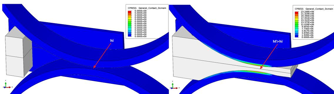
Figure 10: Ecoulement de la poudre et pression de compactage dans le cas de la méthode CEL
