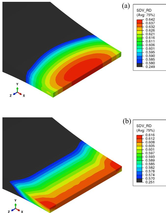
Figure 7: Distribution de la densité relative dans la largeur du compact. Cas plaques fixes (a) et rouleau avec jante (b).
