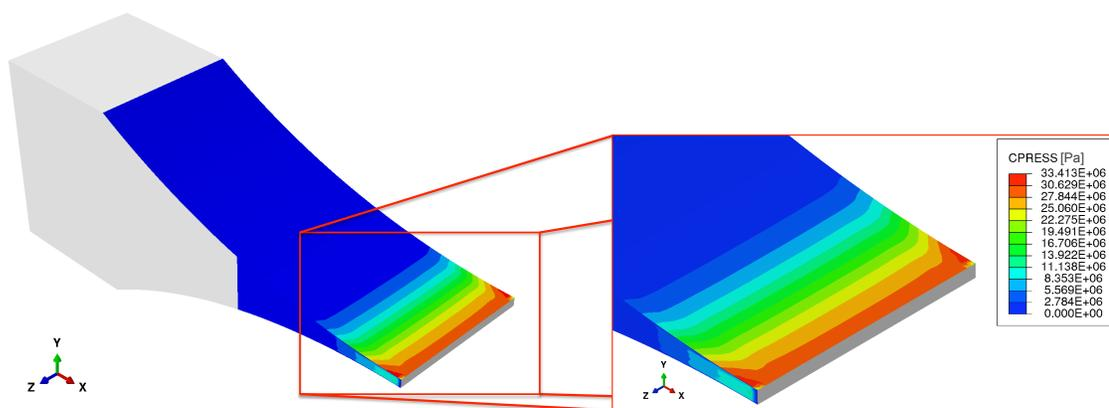
Figure 6: Distribution de pression de contact entre la poudre et le rouleau supérieur. Cas du système de confinement «rouleau surmonté d'une jante».
