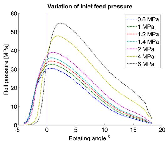
Figure 3: Effet de la pression d'alimentation sur la pression de compactage
