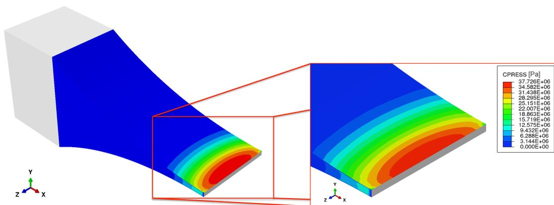
Figure 5: Distribution de pression de contact entre la poudre et le rouleau supérieur. Cas du système de confinement «plaques fixes».
