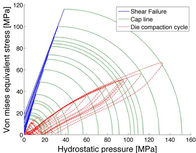
Figure 2: Calibration du modèle de Drucker-Prager Cap pour la cellulose microcristalline MCC101
