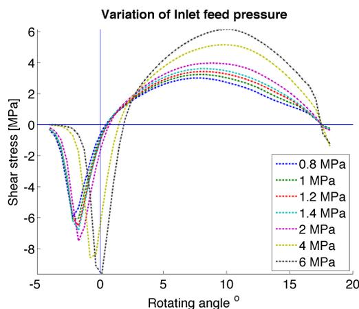
Figure 4: Effet de la pression d'alimentation sur la contrainte de cisaillement
