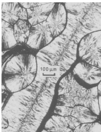
FIGURE C1.2 – Sphérolites et zone transcristalline formés par un PP autour d'une fibre aramide [223]
