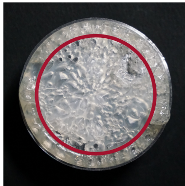
FIGURE C2.7 – Échantillon poreux en fin de synthèse à T_{iso} = 200^\circ\text{C} en rhéomètre. Limite d'analyse représentée par le cercle rouge
