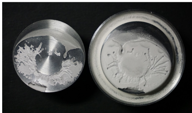
FIGURE C2.4 – Échantillon de rhéologie partiellement évaporé en fin de synthèse à T_{iso} = 150^\circ\text{C}
