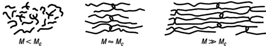
FIGURE A1.9 – Notion de masse critique M_c dans le comportement enchevêtré des polymères
