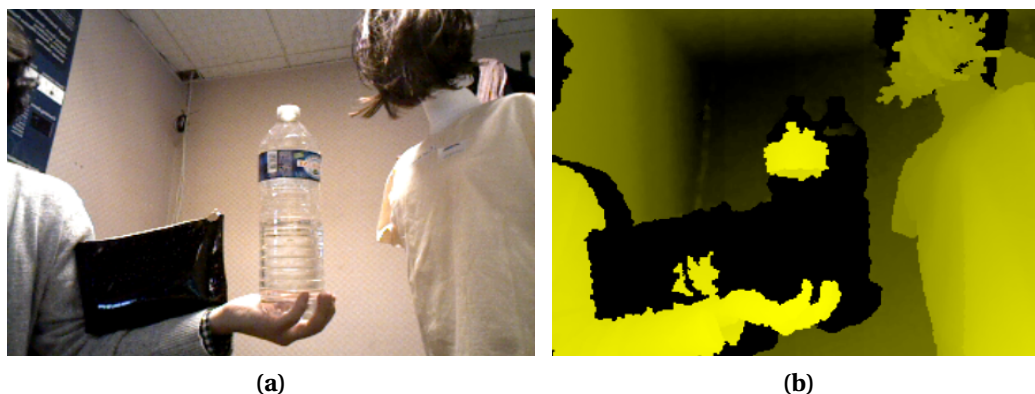
FIGURE 2.13 – Exemple du motif projeté dans une surface hautement réfléchissante et un objet transparent. a) Image couleur avec un portefeuille réfléchissant et une bouteille d'eau transparente en plastique.
