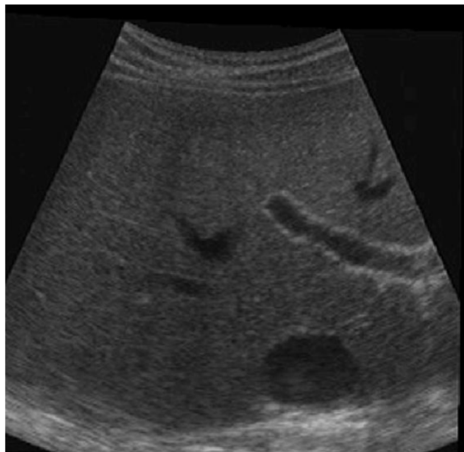
FIGURE 3.5 – Image échographique obtenue sur une maquette d'abdomen en gélatine.
