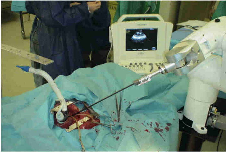
FIGURE 3.7 – Banc expérimental composé d'un robot et d'une sonde échographique utilisés pour insérer un outil dans le ventricule gauche d'un cœur de cochon (Vitrani et al., 2007).
