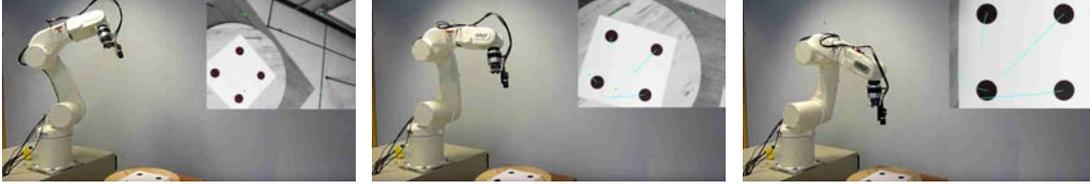
(a) Début du positionnement    (b) Positionnement en cours    (c) Fin du positionnement
