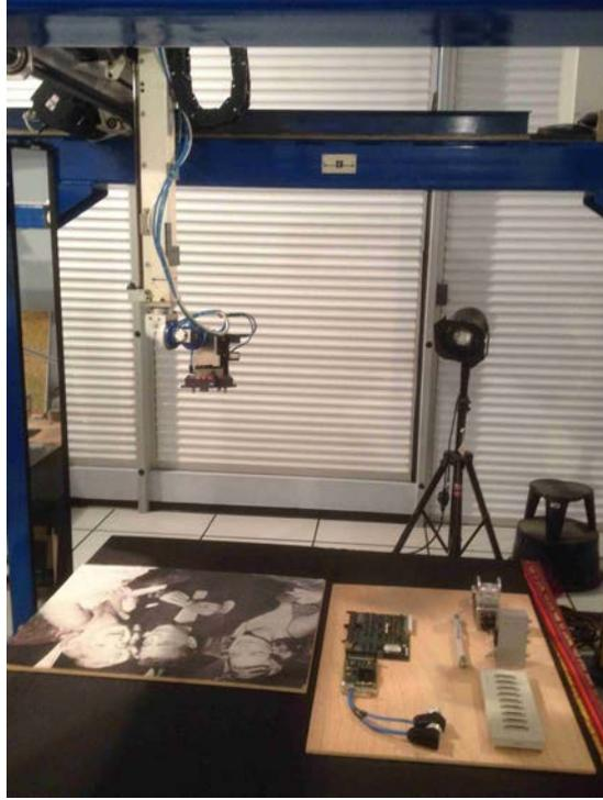
FIGURE 4.12 – Photographie du système expérimental avec une scène planeaire.
