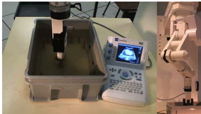
(a) Installation pour validation expérimentale d'asservissement visuel fondé sur les moments géométriques.
