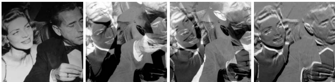
FIGURE 4.23 – [ scenario 3, test 1 ] (a) image désirée \mathbf{I}^* (b) image de différence initiale \mathbf{I}_{diff} , (c) \mathbf{I}_{diff} finale dans le cas e-ondelette , et (d) dans le cas e-shearlet .
