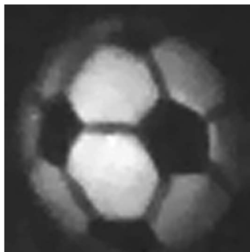
(b) Le même ballon, reconstruit à partir de 1600 mesures aléatoires prises par une caméra SPC.
