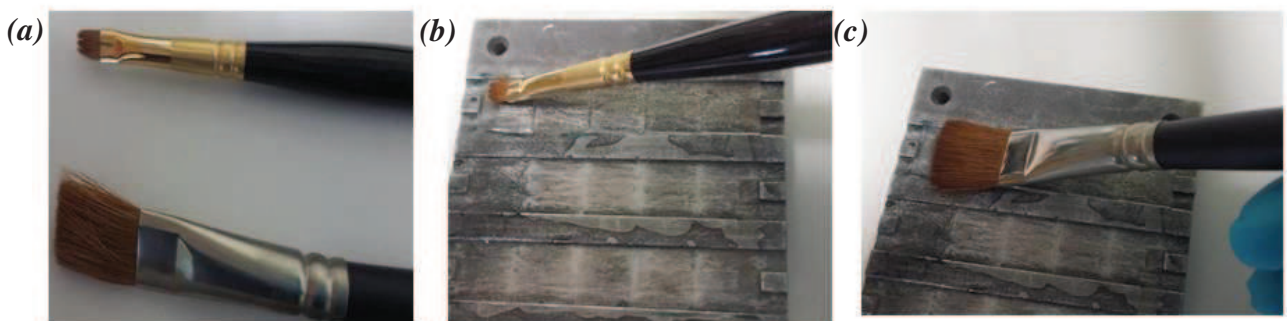
Figure A.2 : (a) images des deux pinceaux, (b) dépôt des AgNWs avec un pinceau de 3 mm, (c) dépôt des AgNWs avec un pinceau de 12 mm sur un substrat en verre.
