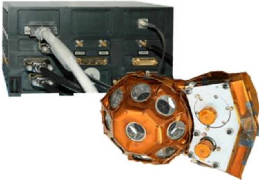
FIGURE 2.13 – Photographie du module électronique de T2L2 relié au module optique et au LRA.
