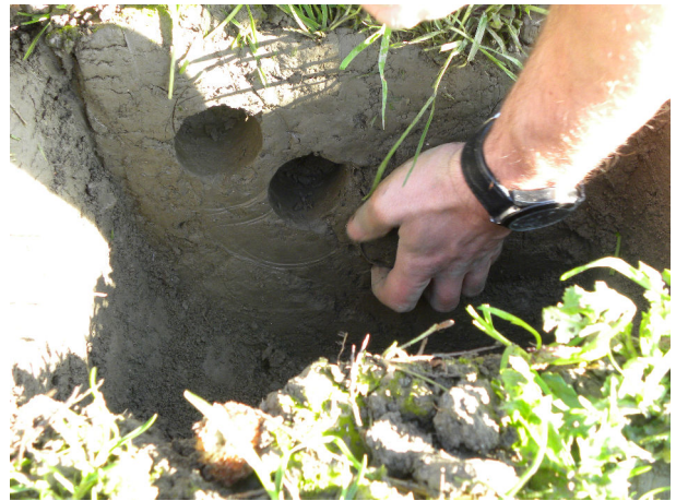
(b) Les prélèvements de sol sont effectués à différentes profondeurs.
