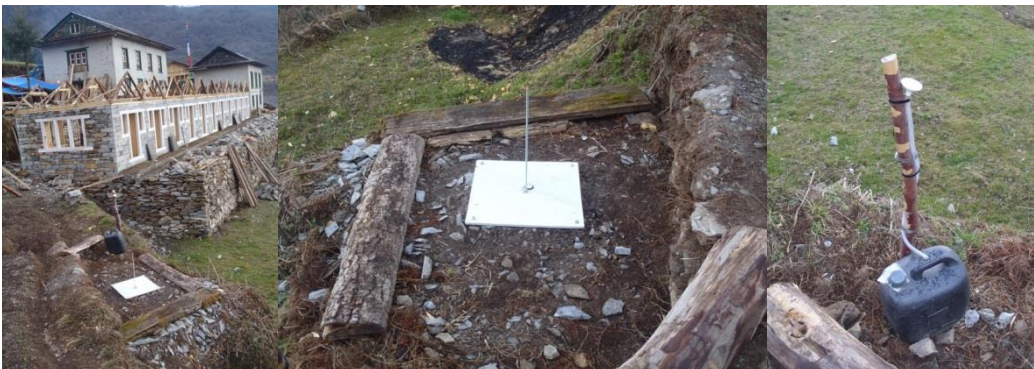
Figure 2 : Planche à neige de Pangom et échantillonneur des précipitations pour analyse isotopique (Photo : L.Neppel).
