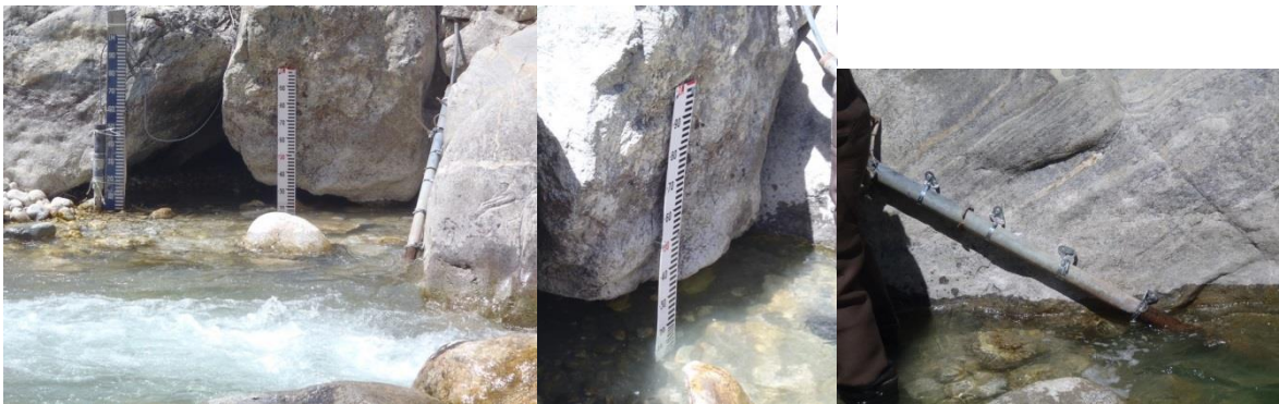
Figure 1 : Nouvelle échelle de crue à Pheriche et fixation du capteur de pression (Photo : L.Neppel)
