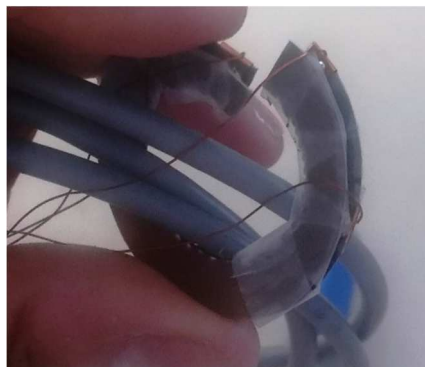
Figure 4.27 : Photo de rondelles en matériau magnétique avec une ouverture en "hélice".
