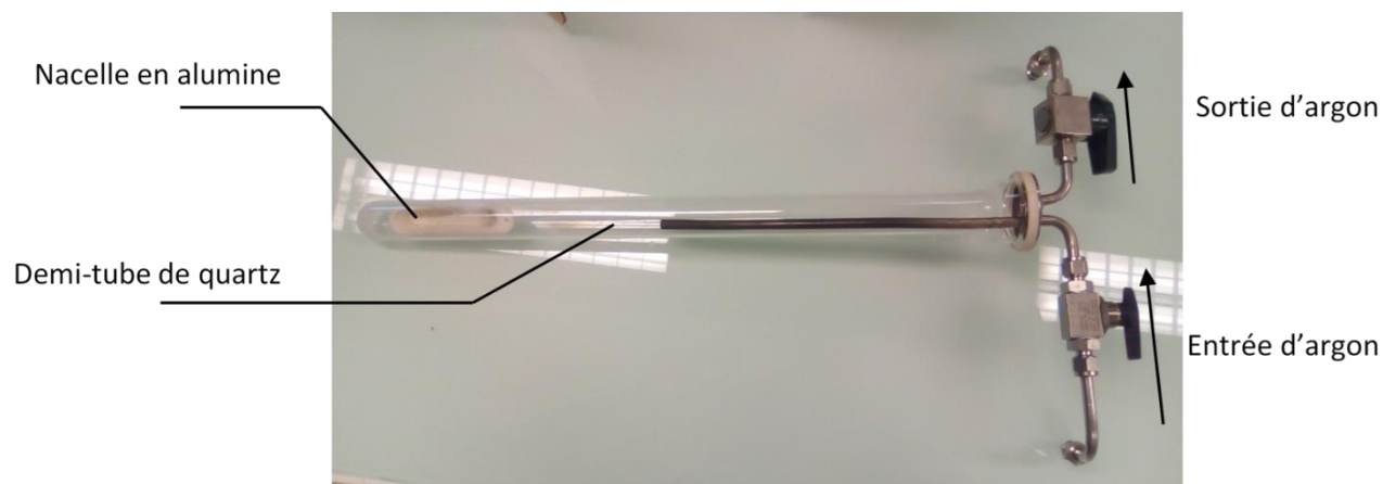
Figure 23. Nacelle d'alumine et demi tube de quartz utilisé pour la synthèse en four tubulaire
