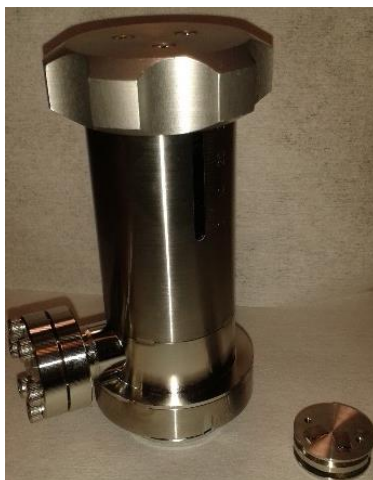
Figure 27. Valise de transfert pour analyses XPS et porte échantillon associé
