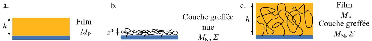
FIGURE A.6 – Schéma représentant les systèmes étudiés dans ce travail. (a) Film de masse moléculaire  $M_P$  et d'épaisseur  $h$  déposé sur la couche d'oxyde d'une pastille de Si. (b) Couche greffée sèche d'épaisseur  $z^*$  constituée de chaînes de masse moléculaire  $M_N$  accrochées à un substrat de Si avec une densité  $\Sigma$ . (c) Film déposé sur une couche greffée et interpénétrée avec celle-ci. L'épaisseur totale est appelée  $h$ .
