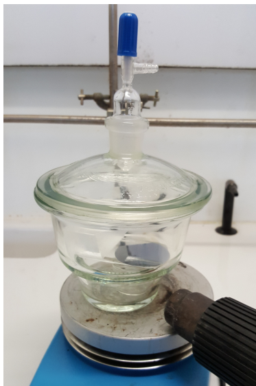
FIGURE 3.12 – Silanisation en phase vapeur. Étape d'évaporation sous vide du silane par chauffage à l'aide d'un décapeur thermique.
