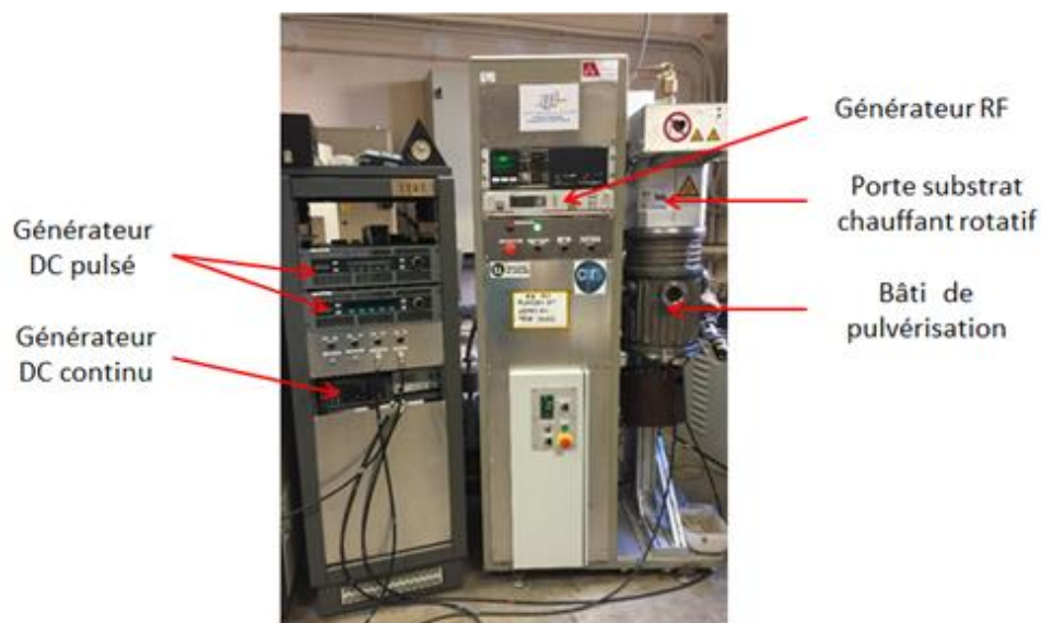
Figure II.3 : Photo de l'installation de pulvérisation cathodique magnétron
