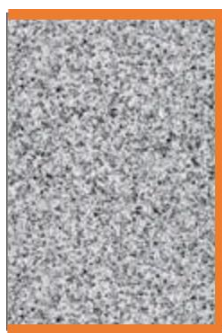
Figure 14 - Echantillon destiné aux essais de lixiviation/immersion résiné sur trois faces
