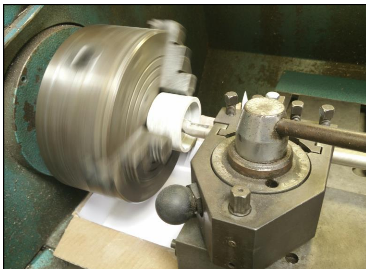
Figure 37 - Alésage de l'échantillon de l'essai d'immersion
